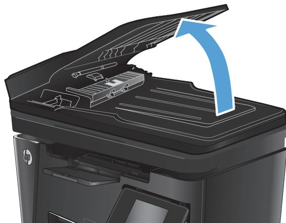
2. Протрите подающие ролики и подающую пластину влажной безворсовой тканью.
