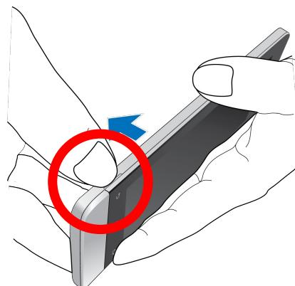
2. Приподнимите крышку и снимите ее.
