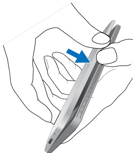
5. Надавите на края задней крышки для ее закрепления.
