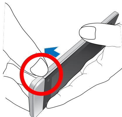
2. Приподнимите крышку и снимите ее.
