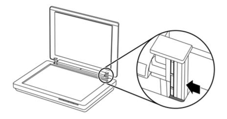
4. Дальше потяните крышку вверх, чтобы снять ее со сканера.
