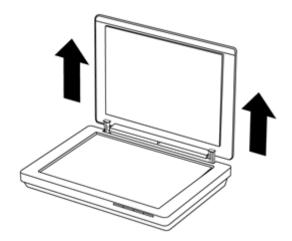
3. Нажмите в нижней части шарнирного соединения крышки сканера.
