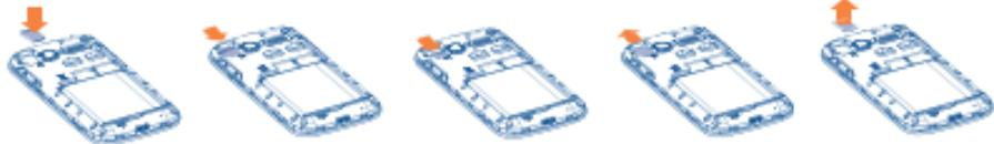
Для установки вставьте microSD-карту в слот контактами вниз. Для извлечения microSD-карты слегка надавите на неё, а затем извлеките её.
