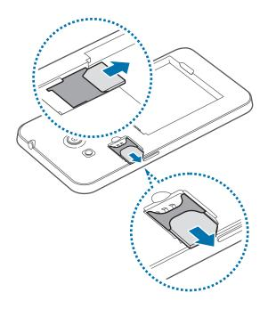
► Модели с одной SIM-картой: Выньте SIM-карту или USIM-карту.
