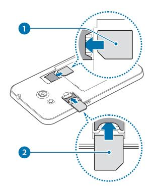
► Модели с одной SIM-картой: Вставьте SIM- или USIM-карту в устройство золотистыми контактами вниз.
