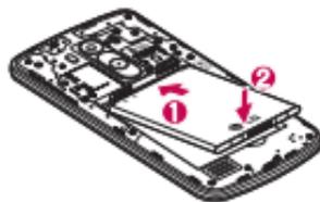
3. Установите аккумулятор в штатный отсек, соединив позолоченные контакты телефона и аккумулятора (1) и нажав на него до щелчка (2).
