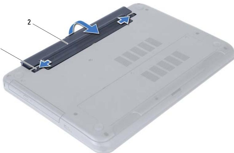
1 фиксаторы аккумулятора (2)
