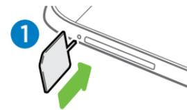
1. Вставьте кончик инструмента для выдвигания лотка (или небольшую разогнутую канцелярскую скрепку) в отверстие рядом с лотком nanoSIM-карты на левой стороне смартфона.
