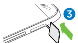
3. С помощью того же инструмента выдвиньте лоток карты microSD™, расположенный на правой стороне смартфона. Вытяните лоток наружу.
