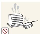
Не устанавливайте блок питания постоянного тока рядом с нагревательными приборами.
