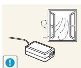
Устанавливайте блок питания постоянного тока в хорошо вентилируемом месте.
