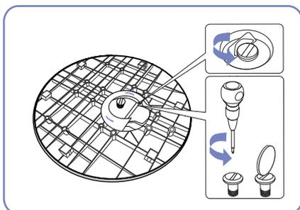
Открутите соединительный винт в нижней части подставки.
