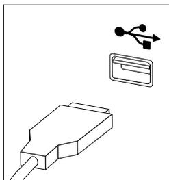
4. Отсоедините кабель неисправной клавиатуры от компьютера и вставьте штекер кабеля новой клавиатуры в тот же разъем.
