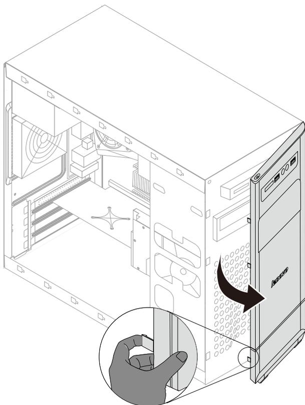
3. Чтобы установить панель на место, выровняйте пластмассовые лапки на нижней части панели с соответствующими отверстиями на раме и закрепите их на верхней и нижней частях рамы.
