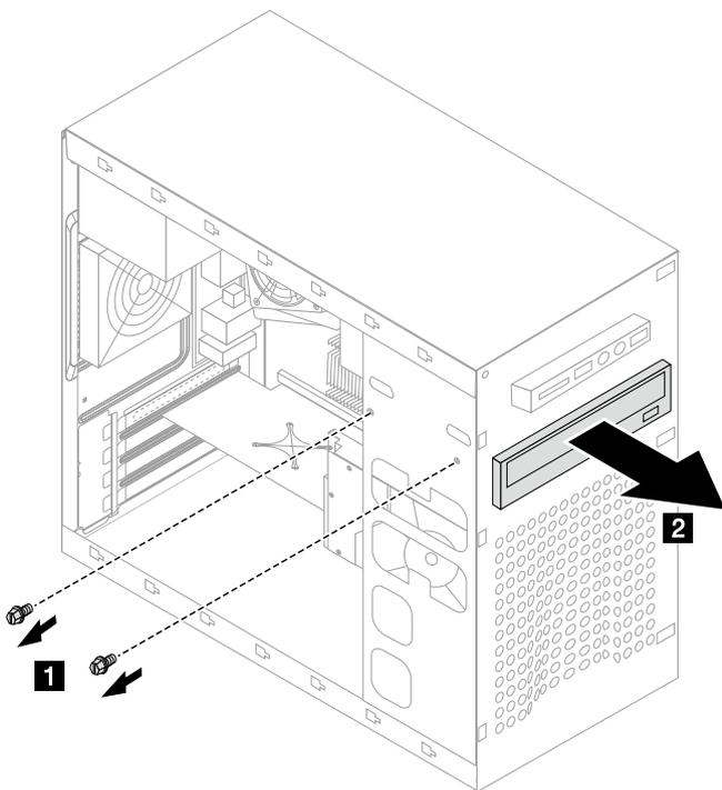
6. Установите новый оптический привод в отсек с задней части таким образом, чтобы он плотно встал на место.
