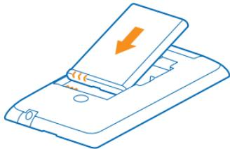
6. Прижмите нижнюю часть задней панели к нижней части телефона.
