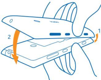
7. Нажмите на заднюю панель, чтобы она зафиксировалась. Не нажимайте на клавиши при установке панели.
