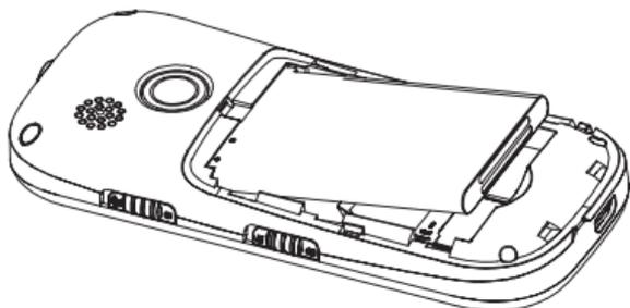
**Внимание!** Перед установкой и извлечением аккумуляторной батареи необходимо отсоединить зарядное устройство. В противном случае возможно повреждение телефона
