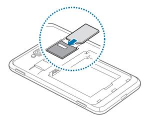
3 Нажмите на SIM- или USIM-карту до щелчка, чтобы зафиксировать ее в разъеме.
