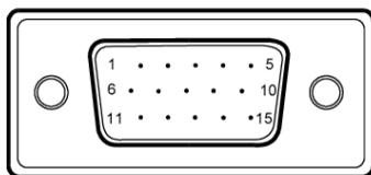
15-контактный сигнальный кабель цветного дисплея
