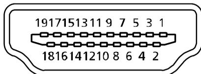
19-контактный сигнальный кабель цветного дисплея\*
