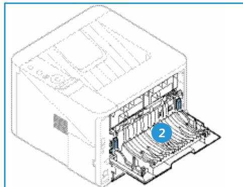
По умолчанию аппарат отправляет готовые отпечатки в *выходной лоток*. Если специальные материалы, например, конверты распечатываются с морщинами, скручиванием или жирными черными линиями, для их вывода следует использовать *заднюю дверцу*. Откройте *заднюю дверцу* и не закрывайте, печать следует выполнять по одному листу за один раз.
