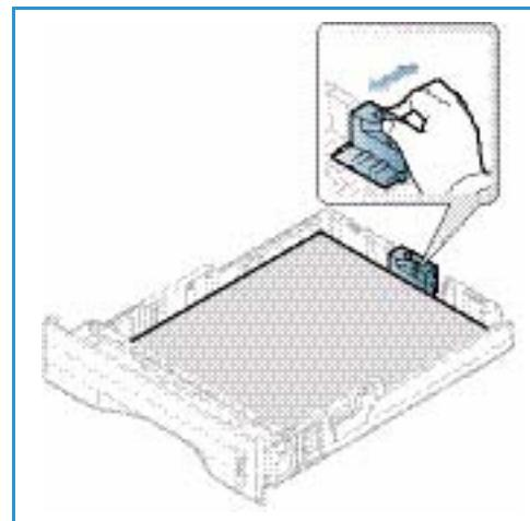
3. Для настройки положения боковой направляющей сожмите рычажок и придвиньте направляющую к стопке бумаги так, чтобы она слегка коснулась стопки.
