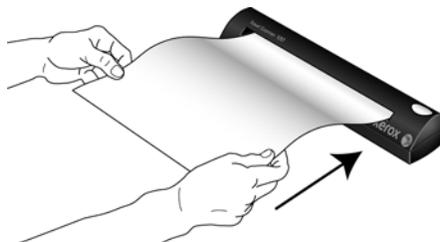
Сканер захватит верхний край бумаги и автоматически начнет сканирование и пропускание бумаги через сканер.
