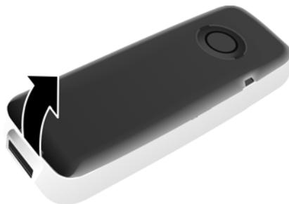
Для **замены аккумулятора** возьмитесь ногтем за выемку в нижней части корпуса и вытащите аккумулятор вверх.
