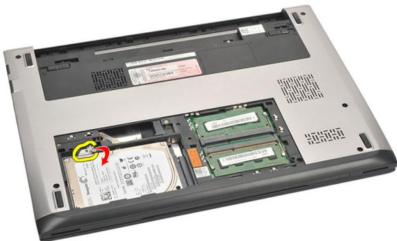
7. Выверните винты, которыми каркас жесткого диска крепится к жесткому диску. Снимите каркас жесткого диска с жесткого диска.
