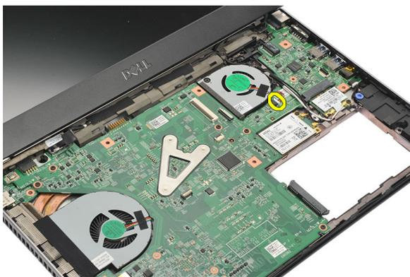
8. Выверните винты, которыми вентилятор крепится к корпусу компьютера.
