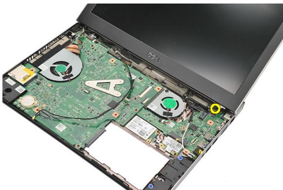
11. Осторожно приподнимите дисплей в сборе и снимите с основания компьютера.
