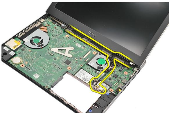
9. Отсоедините кабель дисплея от компьютера и извлеките из направляющего желобка.
