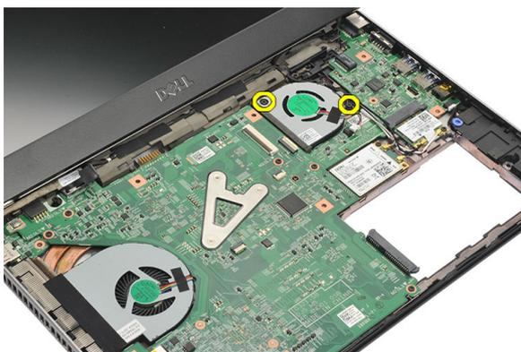
9. Приподнимите вентилятор и извлеките из компьютера.
