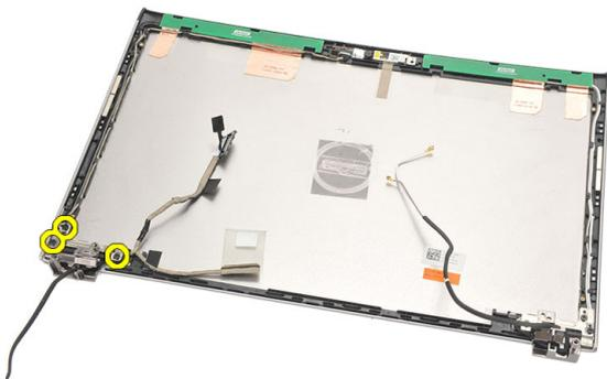
13. Снимите левый шарнир дисплея с дисплея.
