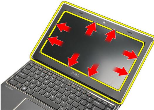
4. Приподнимите лицевую панель дисплея и снимите с дисплея в сборе.
