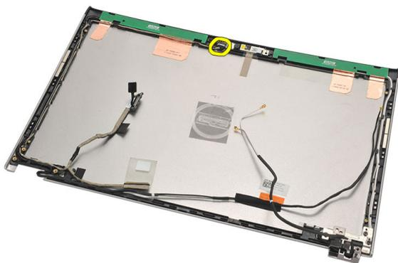
11. Вытяните кабель LVDS из держателя и извлеките из верхней крышки дисплея.
