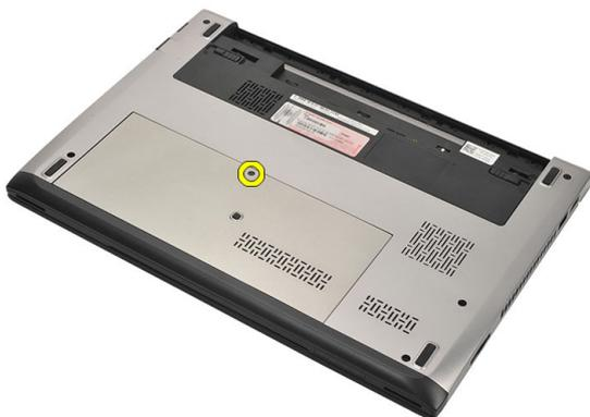
4. Сдвиньте нижнюю крышку к задней части компьютера, приподнимите ее и извлеките из компьютера.
