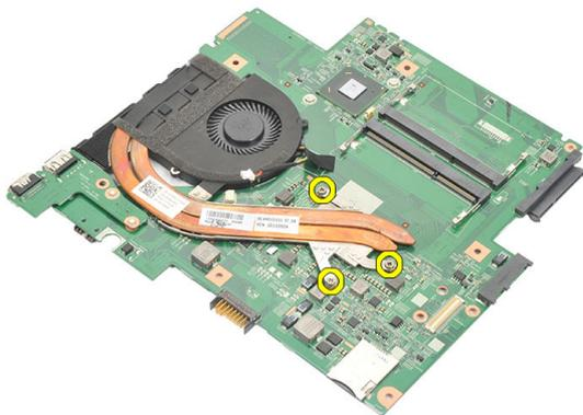
16. Приподнимите радиатор и снимите с системной платы.
