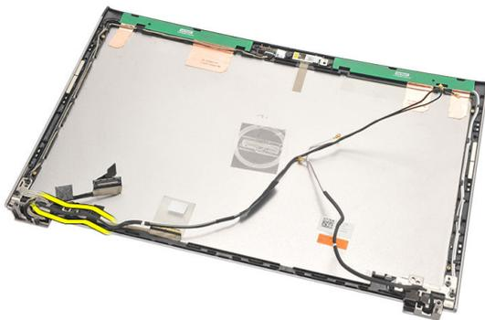
11. Извлеките кабель низковольтной дифференциальной передачи сигналов (LVDS) из левого шарнира дисплея.
