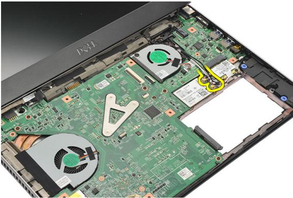
8. Выверните винт, которым плата WWAN крепится к системной плате.
