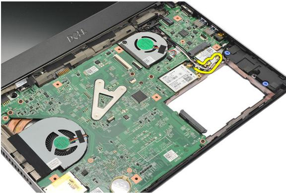
8. Выверните винт, которым плата WLAN крепится к системной плате.
