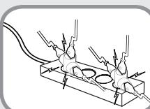
**Не превышайте стандартную мощность (напряжение/ток) мультиштекеров или удлинителей питания при использовании их с данным устройством.**
