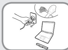
Отсоедините все кабели, подключенные к компьютеру, перед его очисткой. Если ноутбук работает от внешней съемной батареи, отключите внешнюю батарею.
