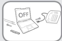
**Перед разборкой компьютера выключите его и отсоедините все кабели. Если имеется модем, отсоедините телефонный кабель. Если ноутбук работает от внешней съемной батареи, отключите внешнюю батарею.**
