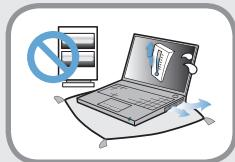
**Во избежание перегрева не используйте компьютер в местах с плохой вентиляцией, например на постельном белье, на подушке и т.д., а также в помещении с подогреваемым полом.**
