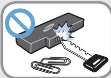
**Не допускайте контакта клеммы батареи (металлические детали) с металлическими объектами, например ключами или зажимами.**
