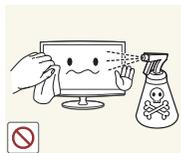
При очистке устройства не распыляйте воду непосредственно на части устройства.
