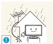
Перегните кабель внешней антенны вниз в месте подсоединения так, чтобы дождевая вода не попадала на него.
