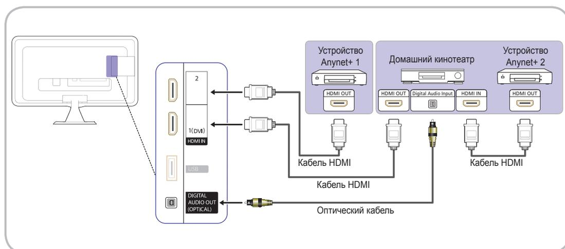
1. Соедините гнездо **HDMI IN (1(DVI), 2)** на телевизоре с гнездом **HDMI OUT** на соответствующем устройстве, поддерживающем функцию AnyNet+, используя кабель HDMI.
