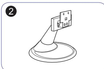
2 Проверьте, надежно ли закреплен соединительный элемент подставки.
