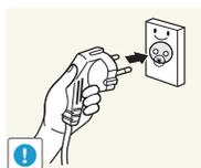
Обязательно подключайте кабель питания к заземленной сетевой розетке (только для оборудования с изоляцией класса 1).
