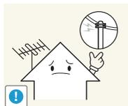
Антенну следует устанавливать вдали от высоковольтных кабелей.
