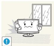
Не устанавливайте устройство в местах, подверженных воздействию влаги (например, сауна), пыли, масел, дыма или воды (например, капель дождя), а также внутри автомобиля.
