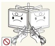
Не пытайтесь поднять или передвинуть устройство, потянув за кабель питания или сигнальный кабель.
