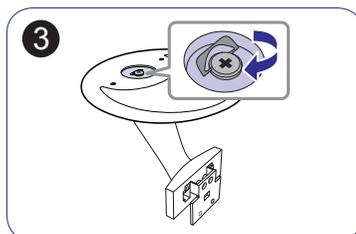
3 Полностью закрутите соединительный винт в нижней части подставки, чтобы как следует зафиксировать соединительный элемент.
