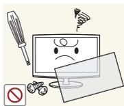
Поскольку в устройстве используется высокое напряжение, никогда не разбирайте, не ремонтируйте его и не изменяйте его конструкцию самостоятельно.
