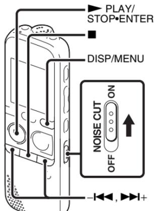
При установке переключателя NOISE CUT в положение “ON” в режиме воспроизведения посторонний шум уменьшается. Файл воспроизводится с более четким звуком, поскольку уменьшается шум во всех частотных диапазонах, включая человеческий голос.
