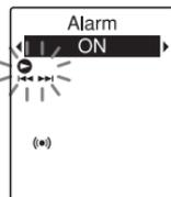
На момент приобретения цифрового диктофона для функции “Alarm” установлено значение “OFF”.
