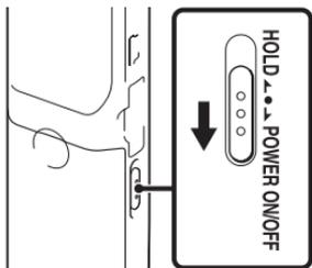
Передвиньте переключатель HOLD•POWER ON/OFF в положение “POWER ON/OFF” более чем на 1 секунду. Цифровой диктофон включится, и на дисплее появится анимационная индикация “Accessing...”.
