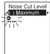
На момент приобретения цифрового диктофона для функции “Noise Cut Level” установлено значение “Maximum”.
