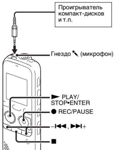
Можно создавать музыкальные файлы без использования компьютера, записывая звук с другого оборудования, подключенного к цифровому диктофону. При выборе “Audio IN” в меню “Scene Select” настройки для записи с другого оборудования уже выбраны. Подробные сведения о настройке см. на стр. 34.
