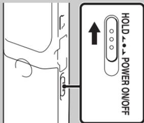
Передвиньте переключатель HOLD•POWER ON/OFF в положение “HOLD”.
