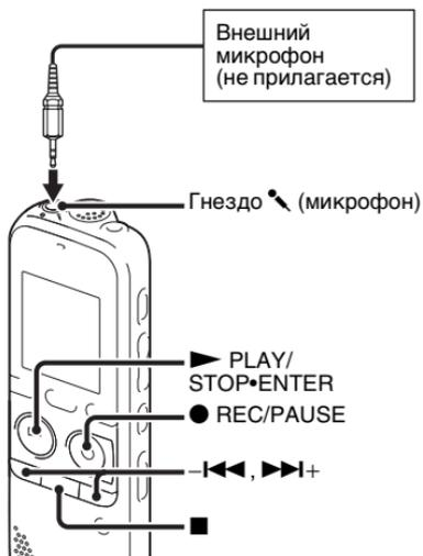
Нельзя выполнить стереофоническую запись звука, если при подключении к цифровому диктофону стереофонического микрофона (не прилагается) для режима записи установлено значение “SHQ” или “HQ”.
