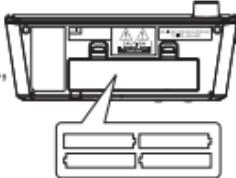
**3** Закройте отсек для элементов питания.
