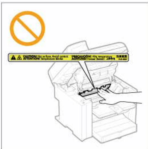
При извлечении застрявшей бумаги или осмотре внутренних частей аппарата избегайте продолжительного воздействия тепла, исходящего из устройства фиксации и области вокруг него. Несоблюдение этого правила может привести к ожогу, даже при отсутствии непосредственного контакта с устройством фиксации.
