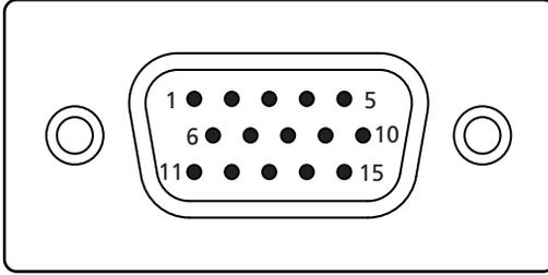
15-контактный сигнальный кабель цветного дисплея
