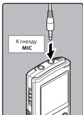
Могут быть подсоединены внешний микрофон или другие устройства, с помощью которых может быть записан звук. Выполните подсоединение к устройству, которое будет использоваться, следующим образом.
