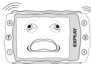
Не допускайте вибраций или ударов в то время когда плеер подключен к PC. Отключайте плеер от PC только через «безопасное отключение устройства».
