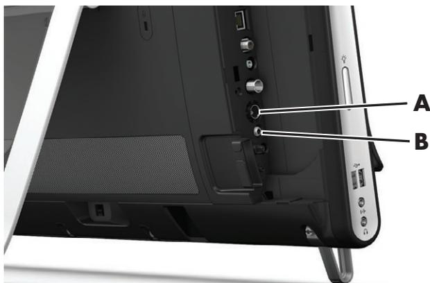
Может потребоваться адаптер входов полного видеосигнала и S-Video (продается отдельно) для подключения выходного разъема видео приставки к входному разъему S-Video **(А)**.
