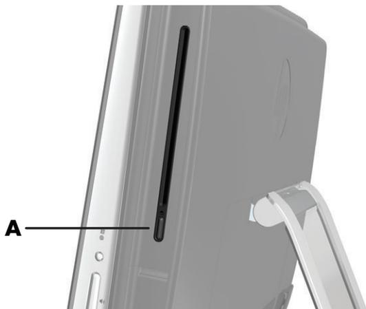
Чтобы извлечь диск, убедитесь, что питание компьютера включено, и нажмите кнопку извлечения (**A**) сбоку от дисковода. Еще один способ извлечения диска: коснуться кнопки **Пуск**, **Мой компьютер**, нажать, не отпуская (или щелкнуть правой кнопкой мыши), значок дисковода компакт-дисков, а затем в контекстном меню выбрать команду **Извлечь**.
