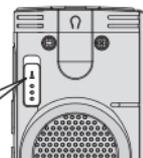
Перед функционированием отмените функцию блокировки Hold, после завершения активизируйте функцию блокировки Hold.
