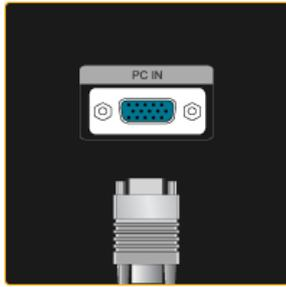
Подключите разъем *PC IN* на задней панели монитора к компьютеру.
