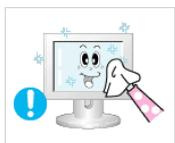
▶ Очистку устройства следует производить только с помощью мягкой ткани и специального чистящего средства для мониторов. При использовании чистящего средства, не предназначенного для очистки мониторов, разбавьте его водой в соотношении 1:10.
