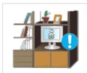
▶ Не устанавливайте устройство в местах с плохой вентиляцией, например в книжном или стенном шкафу.
