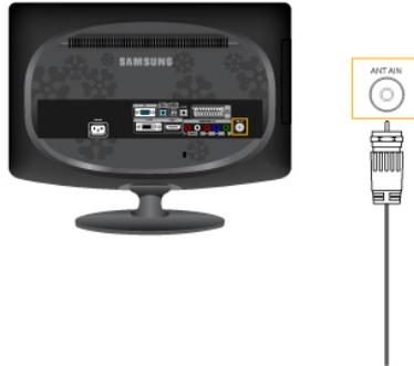
1. Подсоедините кабель CATV или кабель ТВ-антенны к порту «ANT IN» на задней панели монитора.
