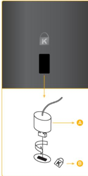
Замок Kensington – это устройство, используемое для физического закрепления системы, когда она используется в общественных местах. Такое устройство приобретается дополнительно. Внешний вид и способ блокировки могут отличаться от изображения в зависимости от производителя. Для получения сведений об использовании замка Kensington см. прилагаемое руководство пользователя. Такое устройство приобретается дополнительно.
