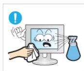
▶ При очистке устройства не распыляйте воду непосредственно на корпус устройства.
