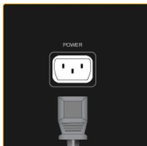
Подключите кабель питания монитора к порту *POWER* на задней панели монитора.
