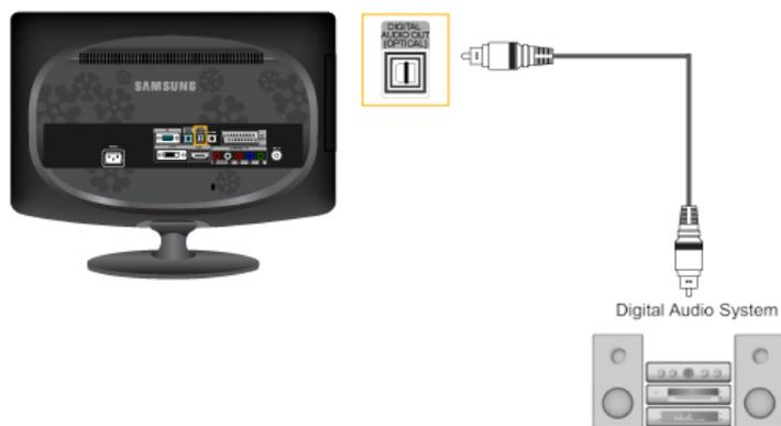
1. Подключите разъем [DIGITAL AUDIO OUT (OPTICAL)] на мониторе к выходному разъему цифрового звука на усилителе цифрового сигнала с помощью оптического кабеля.
