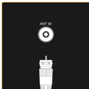
Подсоедините кабель CATV или кабель ТВ-антенны к порту «ANT IN» на задней панели монитора. В качестве кабеля антенны используйте кабель телевизионной антенны (приобретается отдельно).
