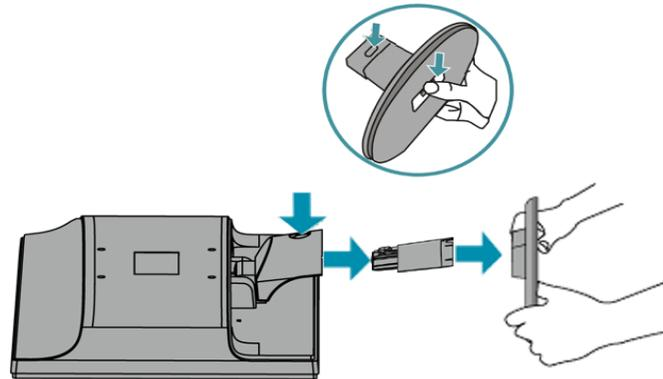
**Примечание:** Этот монитор допускает использование стойки с VESA-совместимым креплением 100ммx100мм.
