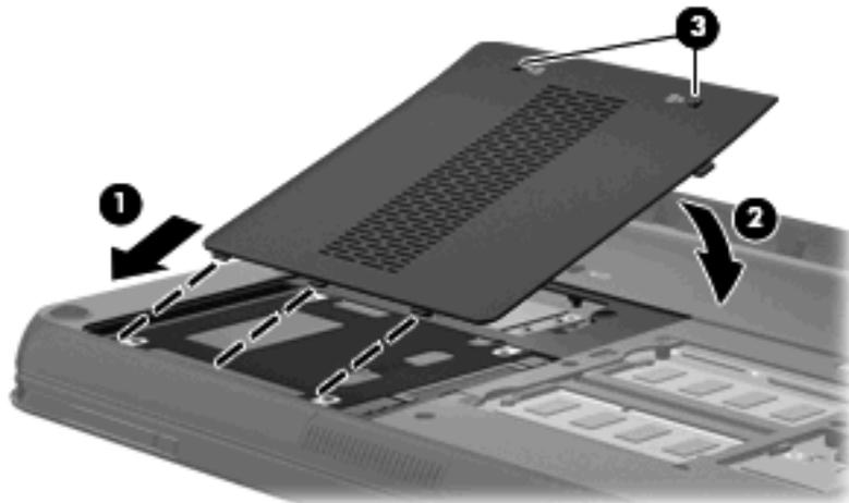
4. Чтобы установить на место крышку отсека для модулей памяти, выполните следующие действия.
