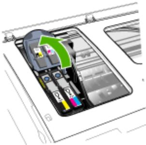
4. Поднимите ручку печатающей головки (которая указана в сообщении на панели управления) и, взявшись за нее, извлеките головку из паза.
