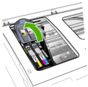
4. Поднимите ручку печатающей головки и взявшись за нее, извлеките головку из паза.
