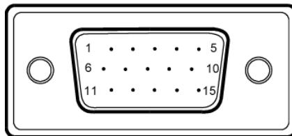
15-контактный сигнальный кабель цветного дисплея
