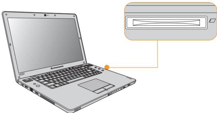
\* Допускается использование только модуля Express Card/34.
