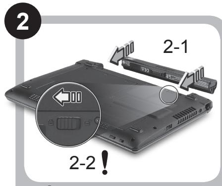
! Проверьте, не заблокирован ли аккумулятор в отсеке, как показано на рис. 2-2.
