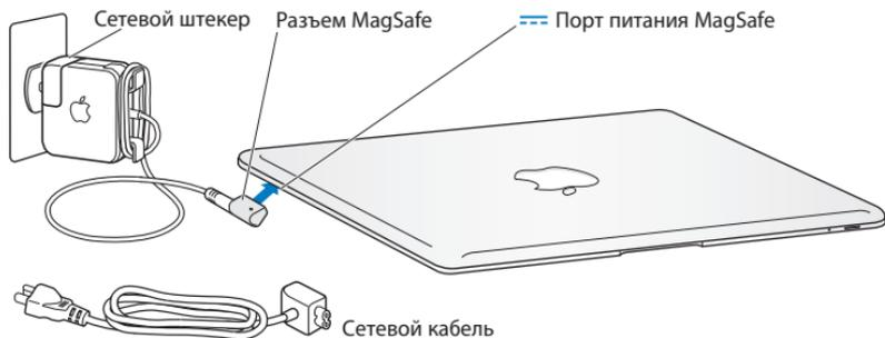
Перед подключением удлиняющего кабеля к адаптеру питания замените сетевой штекер на кабель питания. Сначала извлеките сетевой штекер из адаптера, а затем подсоедините прилагаемый кабель питания к адаптеру. Убедитесь при этом, что он надежно зафиксирован. Вставьте другой конец кабеля в розетку питания.
