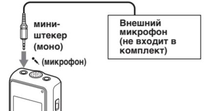
При подсоединении внешнего микрофона внутренний микрофон будет автоматически отключен. При подсоединении микрофона с питанием от устройства, к которому он подключается, питание на этот микрофон будет автоматически подаваться с цифрового диктофона.
