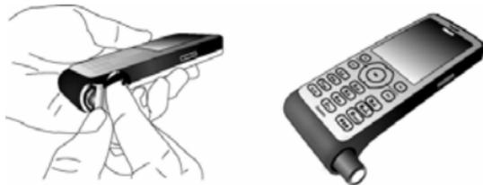
3. Затяните крышку аккумулятора рукой. Затягивайте до упора (крышка должна прочно располагаться в желобке).
