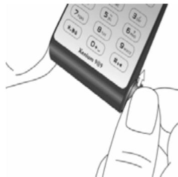
*Если установлен аккумулятор AAA, крышку нельзя вставить внутрь полностью. Останется зазор примерно 5 мм.*
