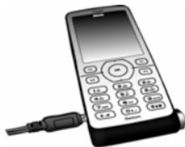
В режиме ожидания два символа аккумулятора иллюстрируют ход зарядки, левый символ - основной аккумулятор, правый - батарея AAA. Во время зарядки изображение левого индикатора меняется; полная зарядка основного аккумулятора занимает около 3 часов.
