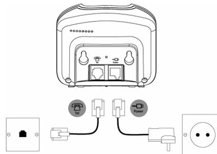
Подключите главный кабель питания к гнезду, обозначенному
