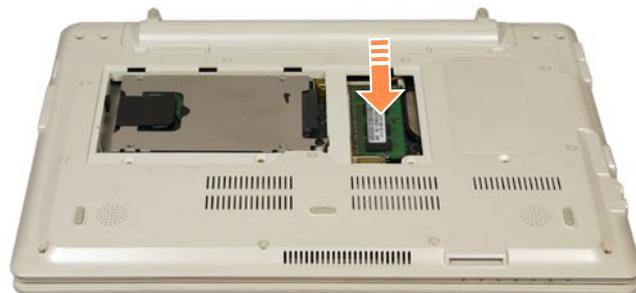
**5** Закройте крышку отсека модуля памяти/жесткого диска и затяните винты.
