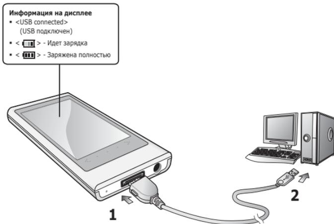
1. Подсоедините USB-кабель большим концом к USB-порту в нижней части проигрывателя.
