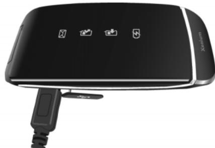
Символ аккумулятора указывает состояние зарядки. Во время зарядки изображение элементов индикатора зарядки меняется; полная зарядка аккумулятора занимает примерно 3 часа. Когда все четыре полоски отображаются постоянно, аккумулятор заряжен полностью. После этого можно отключить зарядное устройство. В зависимости от сети и условий использования время разговоров и время ожидания может доходить до 8 и 750 часов\* соответственно.
