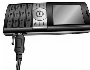
После установки аккумулятора и крышки можно заряжать телефон. Вставьте разъем, как показано ниже. Затем вставьте другой конец в розетку сети переменного напряжения.
