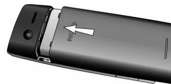
**Будьте осторожны при установке аккумулятора, чтобы не повредить металлические разъемы паза SIM-карты.**
