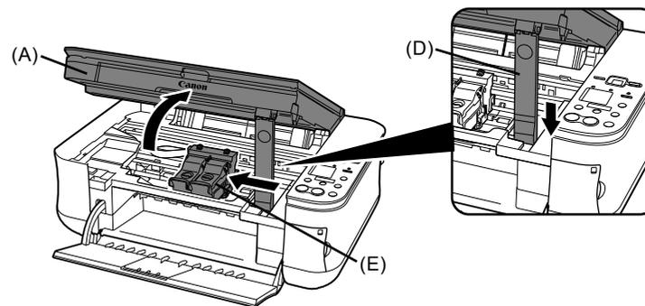
Поднимите модуль сканирования (крышку) (A) до его фиксации.
