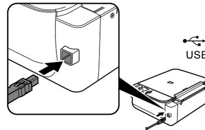
При отображении диалогового окна **[Printer Connection/Подключение принтера]** подключите один конец кабеля USB к компьютеру, а другой — к аппарату и **ВКЛЮЧИТЕ АППАРАТ**.
