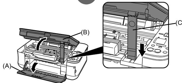
Поднимите модуль сканирования (крышку) (B) до его фиксации.
