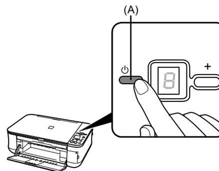
Нажмите кнопку **[ON] (ВКЛ.) (A)** для ВЫКЛЮЧЕНИЯ АППАРАТА.
