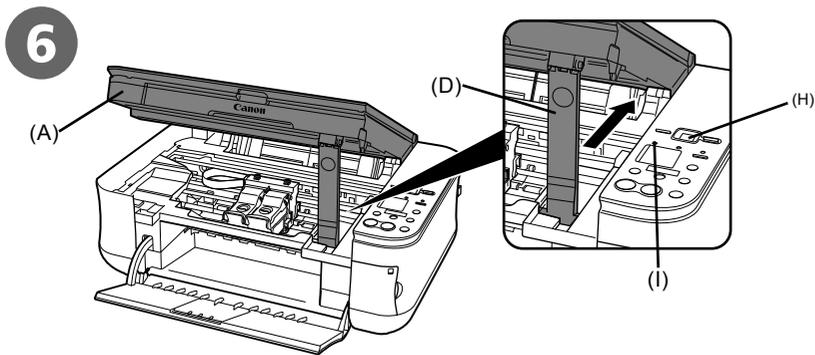
Приподніміть модуль сканування (кришку) (A) і сложіть упор модуля сканування (D), затем акуратно закрийте модуль сканування (кришку) (A).
