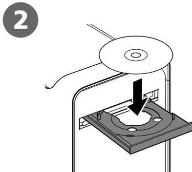
2 Включите компьютер и вставьте [Setup CD-ROM/Установочном компакт-диске] в устройство чтения компакт-дисков.
