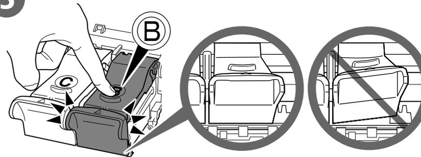
Надавите на (B) до щелчка, чтобы полностью закрыть фиксирующую крышку картриджа с чернилами (B).
