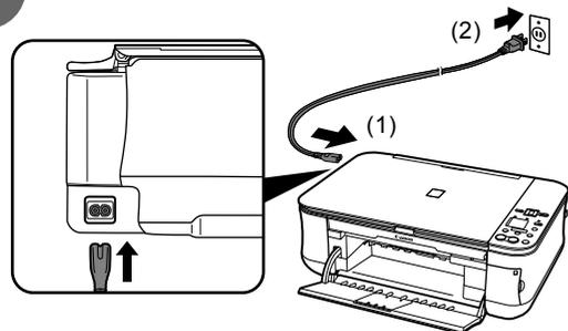
Подключите один конец кабеля питания к разъему на левой стороне аппарата, а другой — к настенной розетке.
