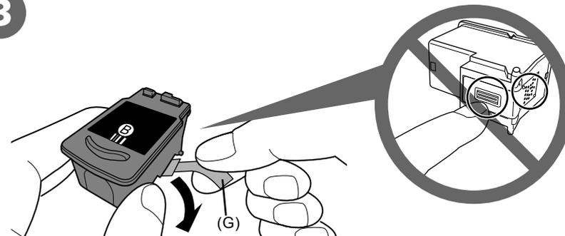
После извлечения черного картриджа FINE (FINE Cartridge) из упаковки потяните оранжевую защитную ленту (G) в направлении стрелки и аккуратно снимите ее.
