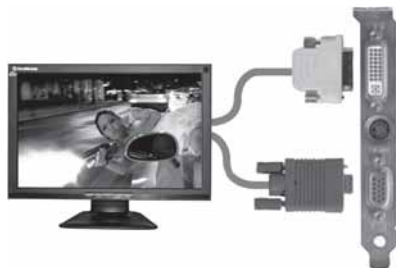
Рис. 2.8. Подключение монитора к компьютеру Kraftway Idea
