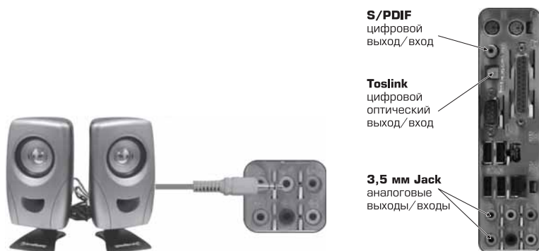
Рис. 6.3. Подключение акустических систем
