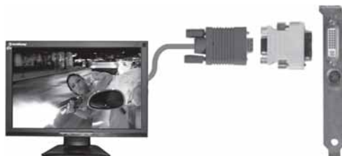
Рис. 2.9. Подключение монитора через переходник DVI/D-Sub
