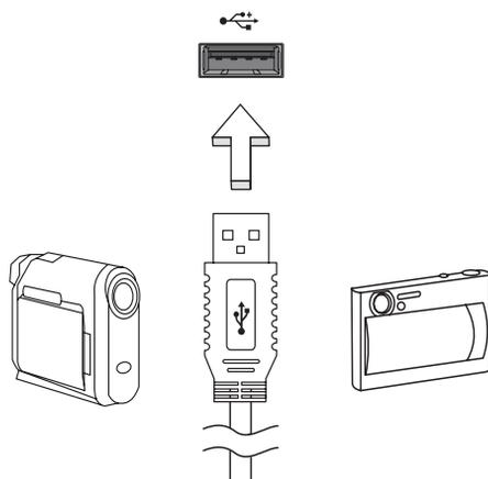
Порт универсальной последовательной шины (USB) 2.0 является высокоскоростной последовательной шиной, к которой можно подключать любые периферийные USB-устройства, не отнимая ценных ресурсов у системы.
