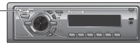
Вы можете снять переднюю панель для защиты устройства от кражи.
