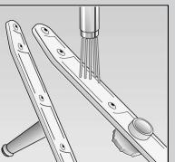
промойте отверстия для разбрызгивания воды в проточной воде (при необходимости воспользуйтесь зубочисткой)...
