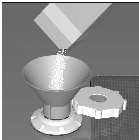
Во избежание возникновения коррозии соль следует загружать непосредственно перед включением машины. В результате перелившийся через край загрузочного отверстия раствор соли будет сразу же разбавлен водой и смыт в канализацию.
