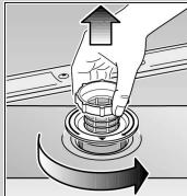
Вращающаяся фильтрующая система фильтров...
