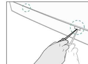
3. Отверните пробку аварийного слива, повернув ее влево. Возьмитесь за конец трубки для аварийного слива и медленно вытяните трубку примерно на 15 см.
