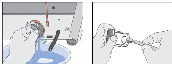
4. Смойте грязь и удалите другой мусор из фильтра. Убедитесь в том, что расположенные сзади фильтра лопасти сливного насоса не заблокированы грязью. Установите на место крышку фильтра.
