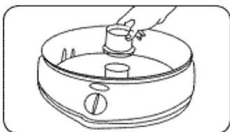
3. Откройте устройство для автоматического сворачивания провода. Отрегулируйте длину шнура питания.
